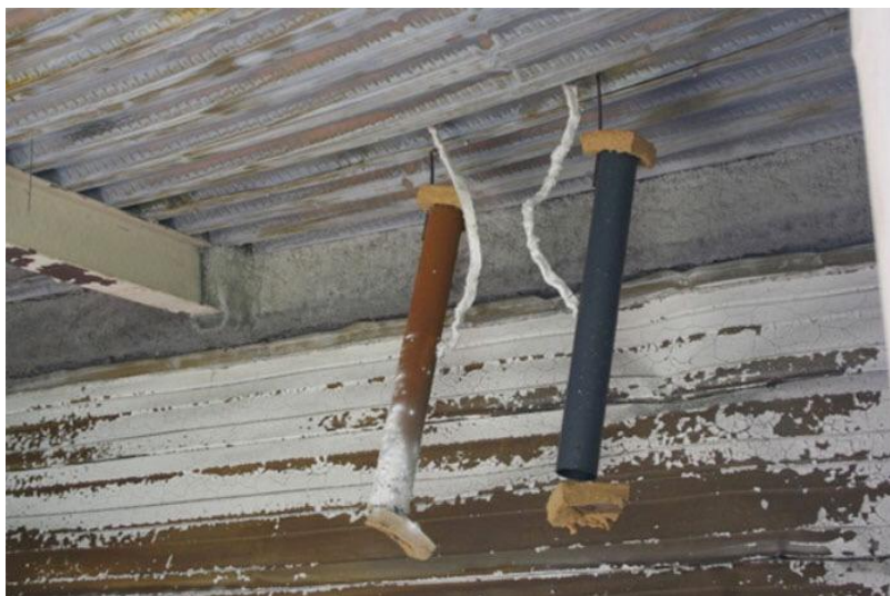
شکل ۳- نمونه‌های آزمایشی، معلق از سقف اتاقک
